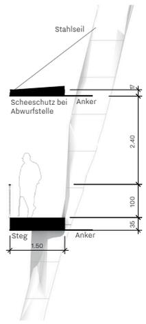
Schnitt Steg und Schutz bei Abwurf M 1:100
